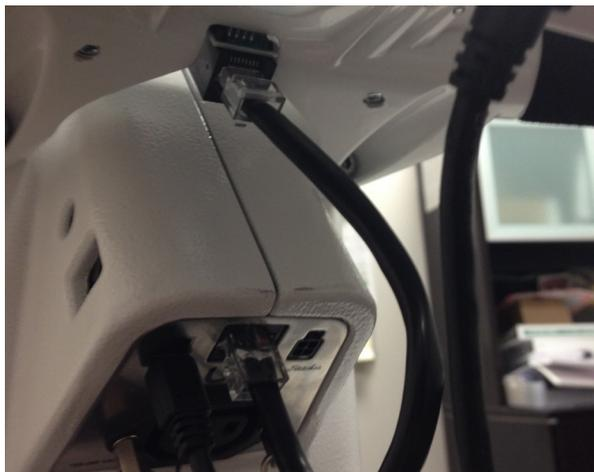
Connectez le connecteur USB mini B à l'arrière de la machine. Vous aurez besoin de l'autre extrémité pour l'écran ultérieurement. Veuillez noter que ce câble alimente l'écran. La prise d'alimentation ronde de l'écran n'est pas utilisée.
