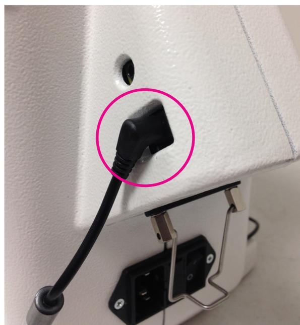
Le laser projette un faisceau laser droit visible sous la forme d'un point sur les surfaces qu'il atteint. Le point du laser sert de guide ou de stylet pour vous permettre d'utiliser des motifs imprimés de pantographe et de piquer le motif sur un quilt en suivant le motif avec le point du laser.
