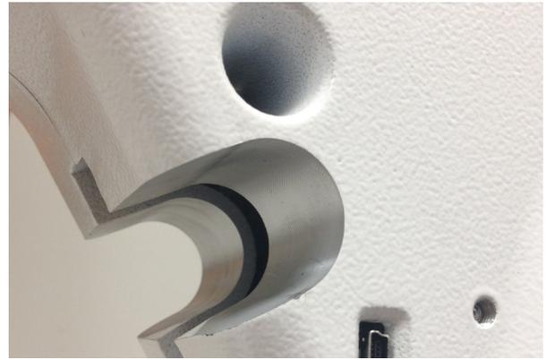
6. En regardant à travers le trou qui se trouve sur le côté gauche de la machine, juste au-dessus de l'encoche en forme de U, repérez et alignez le trou fileté du support de poignées.
