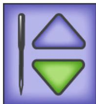
**Bouton d'arrêt de l'aiguille :** appuyez sur le bouton pour alterner entre l'arrêt de l'aiguille en position haute ou basse lorsque vous appuyez sur le bouton Start/Stop (Démarrer / Arrêter pour arrêter de piquer. Votre sélection s'affiche en vert.
