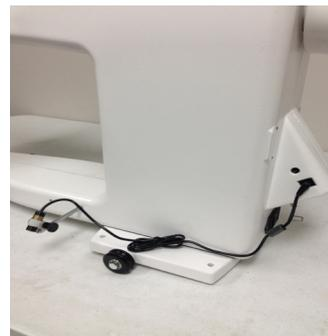
4. Branchez l'extrémité du câble du laser dans le port du stylet laser à l'arrière de la machine. Il se trouve côté tension du déport de la machine, dans l'ouverture rectangulaire.
