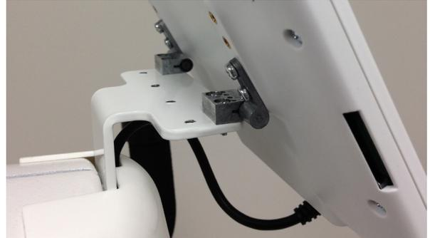
3. Branchez le câble USB mini B (embout à 90°) sortant du capot avant supérieur à l'arrière de l'écran. Ce câble alimente l'écran et établit un signal entre la machine et l'écran. Le port USB en bas à droite de l'écran sert à mettre à jour du logiciel de l'écran et de la machine.
