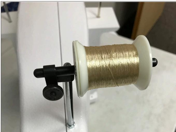
En option, un porte-bobine horizontal est disponible pour les fils délicats comme les fils métallisés ou holographiques ou les fils spéciaux enroulés sur une bobine (non pas un cône). Certains fils se tordent et se cassent en cas d'alimentation depuis une bobine en position verticale.
