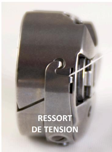
3. Pour insérer le boîtier de canette dans la machine, saisissez-le avec le pouce et l'index. Ne soulevez pas le levier du boîtier de canette. Montez le boîtier de canette sur l'axe du crochet dans la machine. Tournez le boîtier jusqu'à ce que la gorge ouverte s'engage dans l'encoche d'alignement située au milieu du crochet. Poussez le boîtier jusqu'à ce qu'il s'immobilise. Poussez encore le boîtier vers l'intérieur jusqu'à ce qu'il s'enclenche. Laissez le bout du fil pendre librement.
