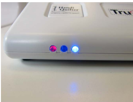
Ilustración 9. Colocación del LED indicador del receptor
