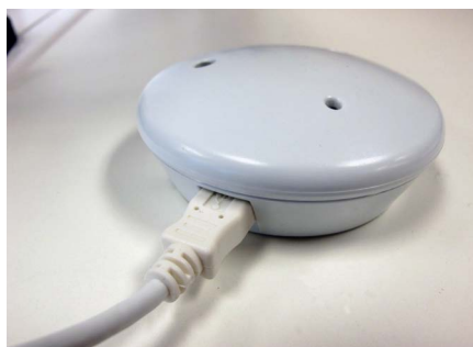
Ilustración 5. Cable de carga instalado. Fíjese que el cable plano está orientado hacia arriba.
