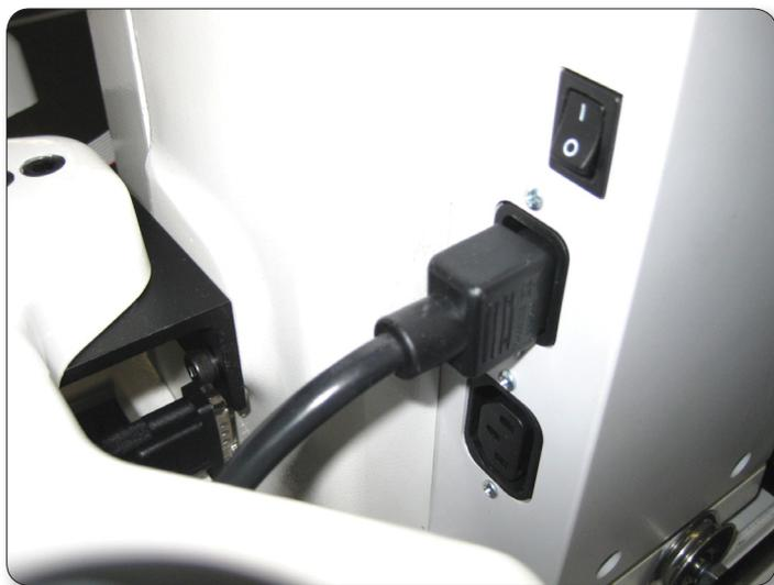
Das Kabel in den obersten Stromanschluss auf der Maschinenrückseite stecken. Das 3-Stift-Ende des Kabels in die Steckdose stecken (s. Abb. 6).
