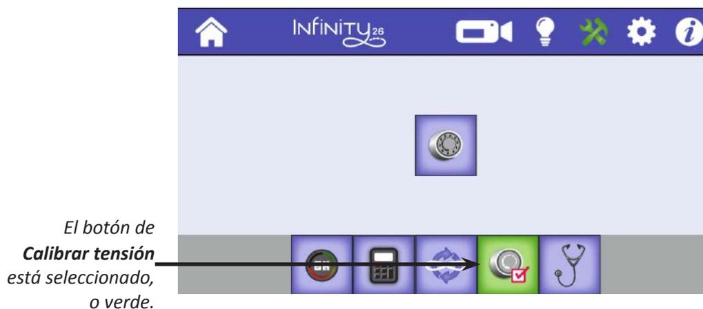
Se tarda aproximadamente treinta segundos en completar la calibración. Es posible que vea el movimiento del tensor mientras está calibrando. La máquina emitirá un pitido cuando se inicie la calibración, cuando esté a la mitad de la calibración y emitirá un pitido ligeramente más largo cuando la calibración se haya completado.
