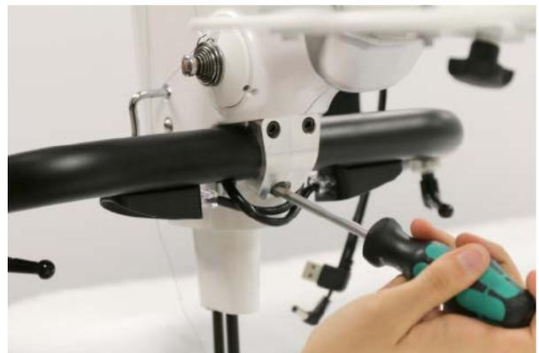
6. Ajuste los manillares hacia delante o hacia atrás hasta una posición cómoda para acolchar y apriete el tornillo inferior con la llave de cabeza hexagonal de 5 mm. Si utiliza la palanca del manillar, apriétela a mano totalmente.
