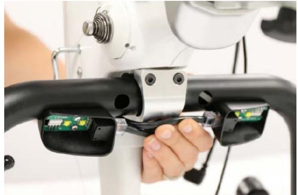
4. Alinee el soporte y los tornillos de cabeza hexagonal con los agujeros de la parte posterior del cabezal de la máquina y apriete firmemente los dos tornillos superiores con la llave de cabeza hexagonal de 4 mm.
