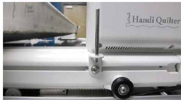
3. Apriete firmemente la tuerca con la llave de cabeza hexagonal de 5 mm. Deslice la abrazadera del láser en el poste de montaje y apriete las dos ruedas de los laterales de la abrazadera.
