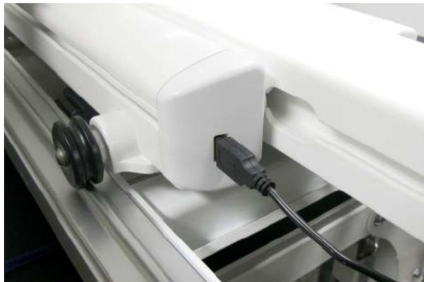
5. Enrolle el exceso de cable en la guía adicional del lado izquierdo de la base de la máquina y utilice una pinza para sujetar el cable.
