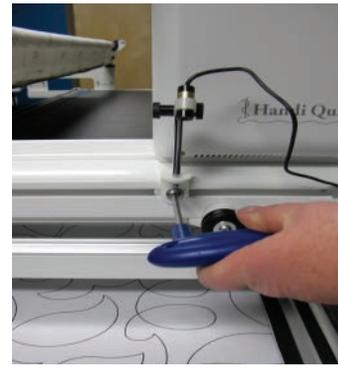
4. Conecte el extremo del cable en el puerto del lápiz láser en la parte posterior de la máquina. Enrolle el exceso de cable alrededor de los manillares posteriores, o bien insértelo en el raíl adicional Handi y utilice una pinza para sujetarlo.
