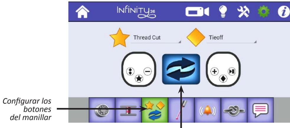
*Pulse para cambiar la configuración del botón para que coincida con la forma en que colocó las etiquetas en los manillares. La imagen del botón izquierdo representa el manillar izquierdo; la imagen del botón derecho representa el manillar derecho.*
