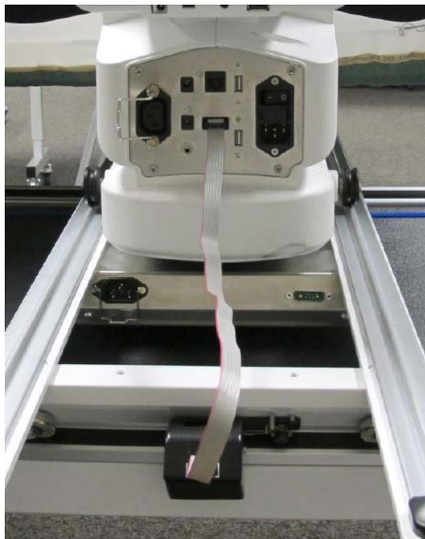
⚡ **IMPORTANTE:** Si alguna vez necesita sacar la máquina del soporte, desenchufe el cable plano del regulador de puntada. De lo contrario, al sacar la máquina del soporte se podrían dañar el cable, los codificadores y el soporte.
