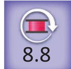
7. Asegúrese de que el icono de alarma está activado (verde), o encendido. Si no es así, toque el icono de alarma para activarla. Cuando el nivel de la canilla llega a cero, la alarma de canilla baja sonará si está encendida.
