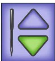
**Botón para detener la aguja:** Toque el botón para alternar entre detener la aguja en la posición de arriba o abajo cuando para de dar puntadas. Su elección se muestra en verde (como se aprecia a la izquierda).
