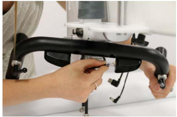
3. Coloque la arandela de 5 mm en los tornillos de cabeza hexagonal M5 e insértelos en los dos agujeros superiores del soporte del manillar.
