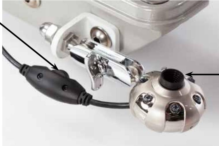
Mit diesem Drehknopf können Sie den Fokus der Kamera steuern.
