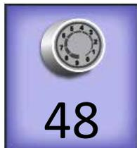
**Easy-Touch Tension™-Taste:** Berühren Sie diese Taste und nutzen Sie dann die Plus- (+) und Minus-Taste (-) auf dem Bildschirm oder den Haltegriffen, um die Oberfadenspannung zu erhöhen oder zu reduzieren. Die Zahl auf der Taste entspricht der aktuellen Einstellung.
