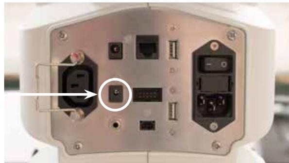
Der Laser projiziert einen geraden Laserstrahl, der auf den Oberflächen, auf denen er auftrifft, als Punkt sichtbar ist. Der Laserpunkt wird als Führungshilfe oder -strahler verwendet, damit Sie gedruckte Pantograph-Designs nutzen und das fortlaufende Muster auf einen Quilt sticken können, indem Sie das Design mit dem Laserpunkt abfahren.
