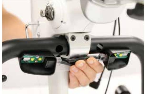
4. Richten Sie die Halteklammer und die Sechskantschrauben an den vorgebohrten Löchern hinter dem Maschinenkopf aus und drehen Sie die zwei oberen Schrauben mit dem 4 mm-Inbusschlüssel fest.
