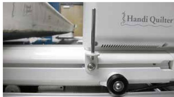
3. Ziehen Sie den Nutzenstein mit dem 5 mm-Inbusschlüssel fest. Schieben Sie die Laserstrahlerklemme auf den Montagestift und drehen Sie die zwei Einstellknöpfe auf den beiden Seiten der Klemme fest.
