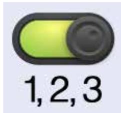
Durch Berühren der Taste für alle Leuchten (1,2,3) werden alle Leuchten zusammen eingeschaltet. Falls die Leuchten bereits eingeschaltet sind, können Sie diese Taste berühren und so alle Leuchten zusammen ausschalten.
