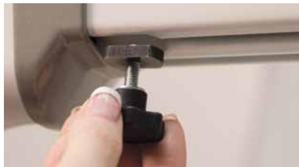
3. Schieben Sie den Schlitz der Fadenspulenablage auf den Bolzen des Einstellknopfes. Drehen Sie den Einstellknopf mit der Hand fest, bis die Fadenablage fest am Arm der Maschine anliegt.
