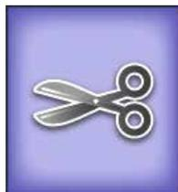
**Taste zum Abschneiden des Spulenfadens:** Berühren Sie diese Taste, um einen Spulenfaden abzuschneiden. Die HQ Infinity schneidet den Faden an der Nadelöffnung in der Stichplatte ab, sodass ausreichend Spulenfaden verbleibt, um ihn das nächste Mal an die Oberseite des Quilts zu ziehen.
