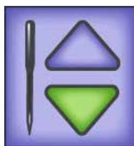
**Taste für Nadelstopp-Position:** Berühren Sie die Taste, um zwischen der Nadelstopp-Position (oben oder unten) zu wechseln, in der die Nadel anhält, wenn Sie den Nähvorgang unterbrechen. Ihre Auswahl wird grün hervorgehoben (siehe Abbildung links).
