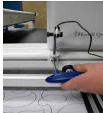
4. Stecken Sie das Kabelende in den Anschluss für den Laserstrahler auf der Rückseite der Maschine. Wickeln Sie das verbliebene Kabel um die hinteren Haltegriffe oder stecken Sie es in die Handi-Zubehörschiene und fixieren Sie das Kabel mit einer Klemme.
