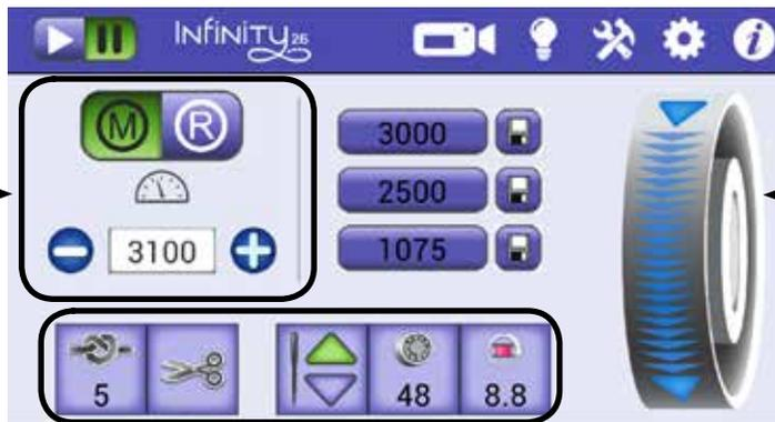
Über das Handrad auf dem Bildschirm mit dem Hauptmenü können Sie das Handrad der Maschine drehen. Sie müssen also nicht um die Maschine greifen und das Rad per Hand drehen.
