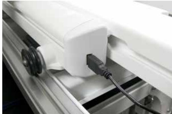
5. Verstauen Sie das verbliebene Kabel im Zubehörschacht auf der linken Seite der Maschine und fixieren Sie das Kabel mit einer Klemme.
