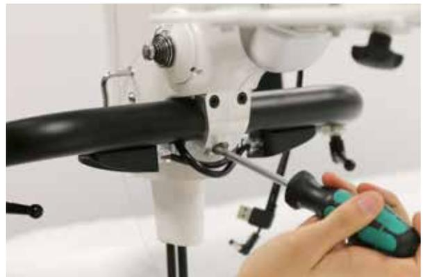
6. Bringen Sie die Haltegriffe durch Vor- und Rückwärtsschieben in eine Position, in der Sie bequem quiltern können, und drehen Sie die untere Schraube mit dem 5 mm-Inbusschlüssel fest. Wenn Sie den Spannhebel verwenden, müssen Sie diesen vollständig mit der Hand festziehen.
