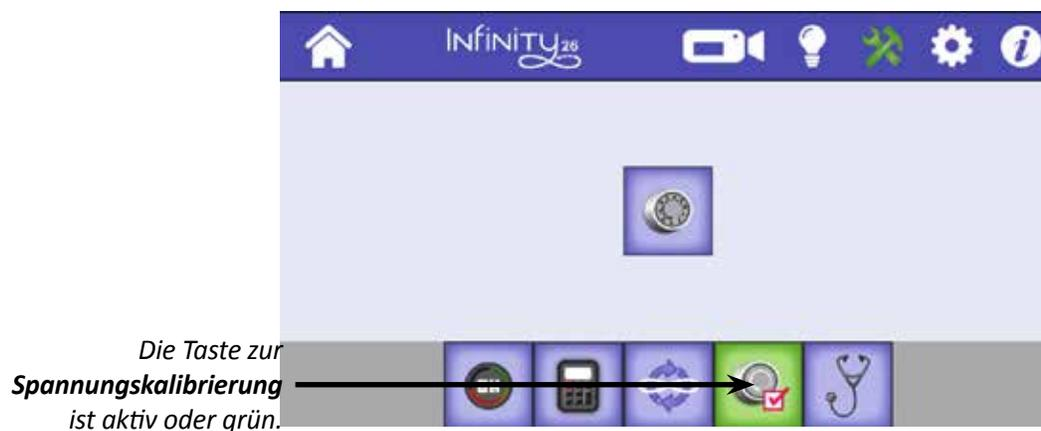
Die Kalibrierung dauert ca. 30 Sekunden. Sie können dabei sehen, wie sich der Fadenspanner bewegt. Zu Beginn und etwa nach der Hälfte der Kalibrierung ertönt ein Piepton. Wenn die Kalibrierung abgeschlossen ist, wird von der Maschine ein etwas längerer Piepton ausgegeben.
