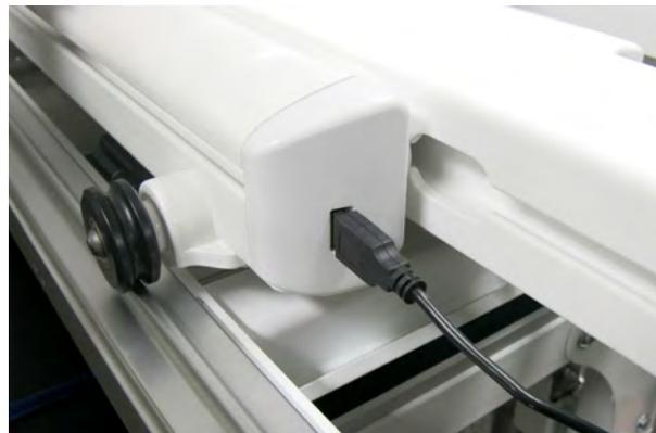
5. Faites rentrer l'excès de câble dans le rail pour accessoires situé à gauche du socle de la machine et utilisez un serre-câble à rainure en T pour fixer le câble.
