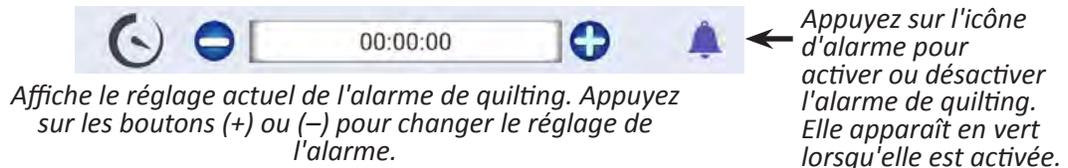
1. Spécifiez le temps qui doit s'écouler avant que l'alarme se déclenche. Affinez le réglage de l'alarme en appuyant sur les boutons (+) ou (-), qui modifient le réglage de l'alarme d'une minute à la fois.
