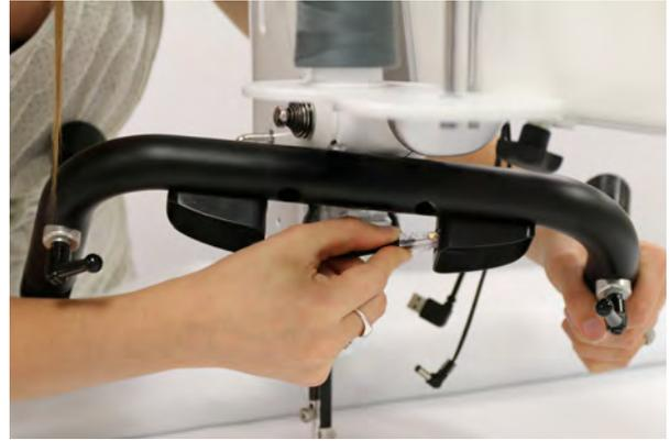
3. Placez la rondelle de 5 mm sur les vis à tête hexagonale M5 et insérez-les dans les deux premiers trous du support de poignée.
