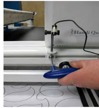
4. Branchez l'extrémité du câble dans le port du stylet laser à l'arrière de la machine. Enroulez l'excès de câble autour des poignées arrière, ou insérez-le dans le rail pour accessoires Handi et utilisez le serre-câble à rainure en T pour le fixer.
