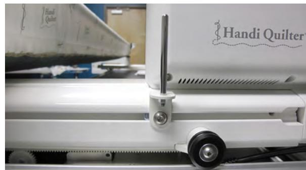
3. Serrez l'écrou en utilisant la clé hexagonale de 5 mm. Faites glisser la pince du laser sur le support de montage et serrez les deux molettes sur les côtés opposés de la pince.
