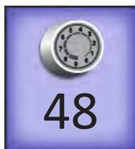
**Bouton Easy-Touch Tension™** : appuyez sur ce bouton, puis utilisez les boutons (+) et (-) sur l'écran ou les poignées pour augmenter ou diminuer la tension supérieure. Le nombre sur le bouton indique le réglage actuel de la tension.
