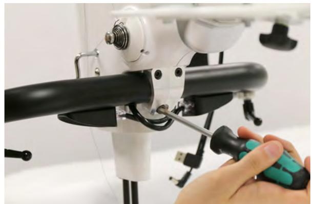
6. Réglez les poignées vers l'avant ou l'arrière jusqu'à obtenir une position confortable pour le quilting et serrez la vis du bas avec la clé hexagonale de 5 mm. Si vous utilisez le levier de poignée, serrez à fond à la main.
