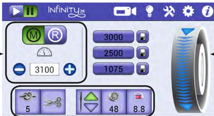
Le volant à l'écran vous permet de tourner le volant de la machine depuis l'écran principal au lieu d'étendre le bras autour de la machine pour le faire manuellement.
