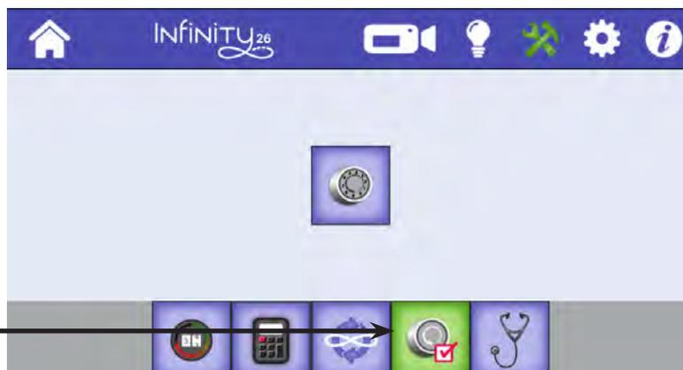
Il faut compter environ 30 secondes pour effectuer l'étalonnage. Vous pouvez voir le mouvement du tendeur pendant l'étalonnage. La machine émet un bip au début et à la moitié de l'étalonnage, et un bip légèrement plus long à la fin de l'étalonnage.
