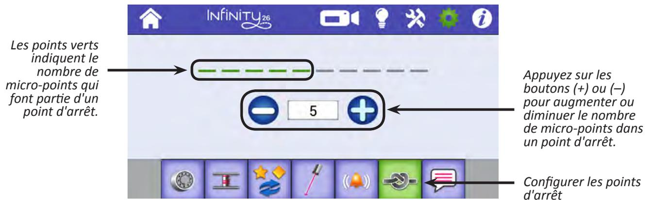
Après avoir indiqué le nombre de points dans un point d'arrêt automatique, utilisez le bouton Point d'arrêt de l'écran principal pour effectuer le point d'arrêt. Appuyez sur le bouton et déplacez doucement la machine pour effectuer les micro-points.
