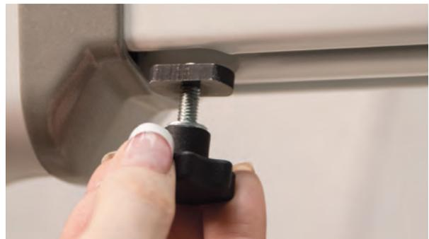
3. Faites glisser la fente du plateau de bobine de fil sur le boulon de la molette. Serrez la molette à la main jusqu'à ce que le plateau de bobine de fil soit bien maintenu contre la gorge de la machine.
