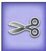
**Bouton coupe-fil de canette** : appuyez sur ce bouton pour effectuer une coupe du fil de canette. L'Infinity coupe le fil au niveau de l'ouverture de l'aiguille dans la plaque d'aiguille, en laissant suffisamment de fil de canette pour votre prochaine remontée.
