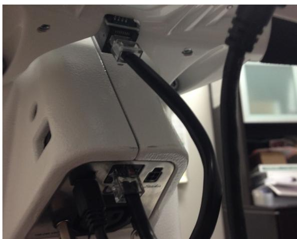
Connectez le connecteur USB mini B à l'arrière de la machine. Vous aurez besoin de l'autre extrémité pour l'écran ultérieurement. Remarquez que ce câble alimente l'écran, la prise électrique ronde sur l'écran n'est pas utilisée.
