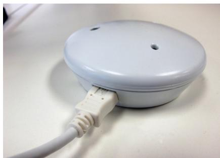
**Figure 5.** *Câble de chargement installé. Veuillez noter que le méplat sur le câble se trouve en haut.*
