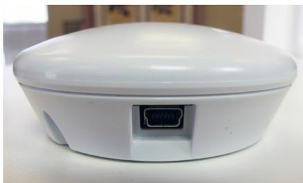
**Figure 4.** *Prise de chargement de type USB Mini-B sur le contrôleur TruStitch.*
